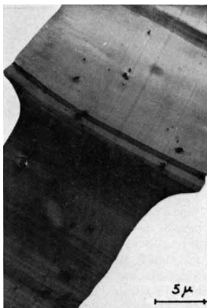
Fig. 30. Etirage de 100% dans le butanol; fil 2GT de 22\ \mu , coupe longitudinale, pénétration du nitrate d'uranyle.
