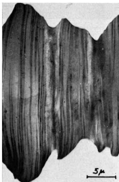
Fig. 31. Etirage de 100% dans le butanol; fil polypropylène de 30 \mu , coupe longitudinale, pénétration du nitrate d'uranyle.
