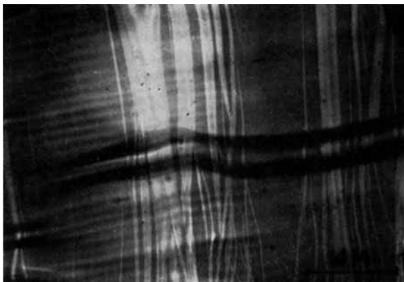
Fig. 28. Etirage de 10% dans le butanol; fil 2GT de 22\ \mu , coupe longitudinale.
