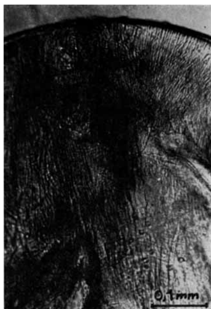
Fig 13. Etirage de 10% dans le butanol; crin 2GT de 100/100 ème, coupe transversale.
